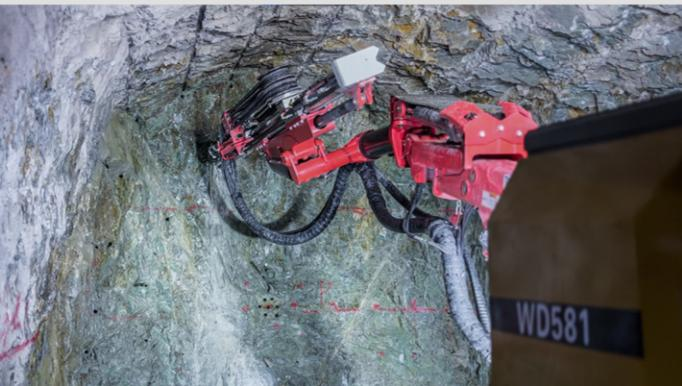
Sistema de alta eficiencia y control rápido electroproporcional de la perforación, incluyendo la perforación automática, retracción y liberación automática de atascos y otras funciones.
