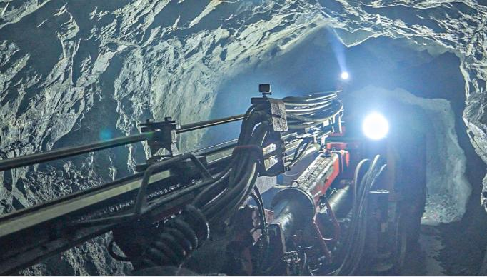
Adopta un sistema de perforación de control hidráulico electro-proporcional de alta eficiencia y rapidez, incluyendo perforación automática, retracción automática, liberación automática del brasero de atasco y otras funciones.
