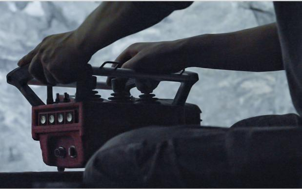
Mando a distancia eléctrico proporcional hidráulico sistema de control inteligente, no hay puntos ciegos en el campo de visión durante el funcionamiento, el personal se mantiene alejado de Ajuste visual de los parámetros de funcionamiento, que puede ser pre-diseñado para responder con flexibilidad a las diferentes condiciones de trabajo.
