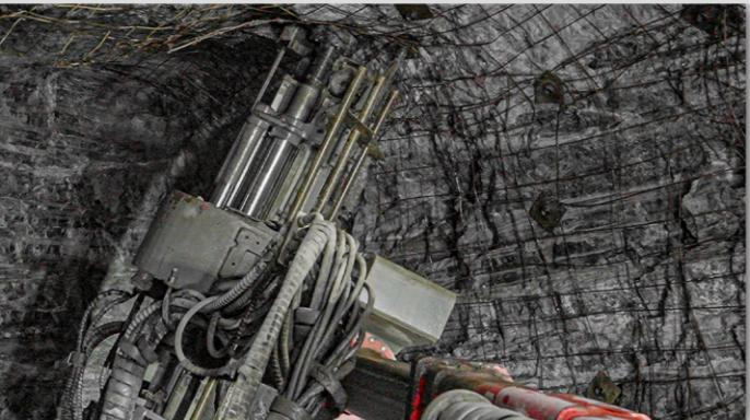
La unidad de instalación de anclajes MBU es un sistema totalmente mecanizado para la manipulación de anclajes de alta productividad con un cargador que admite hasta 10 pernos y con capacidad para anclajes de longitud entre 1,5 y 2,4 metros.
